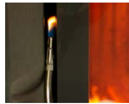
Türdichtungen können mit einem Feuerzeug auf Dichtheit geprüft werden.
