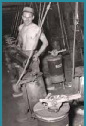
Beschicken der Brennkammern von oben mit Kohle (Göggingen).
