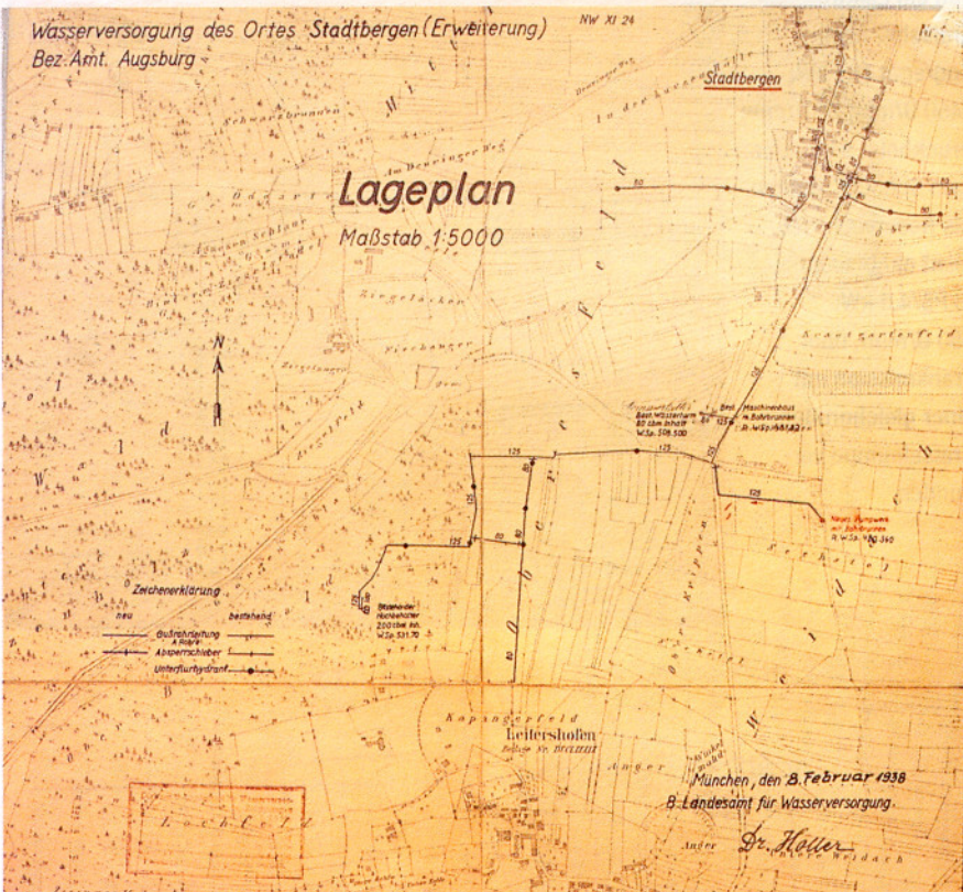
Bild 10: Pumpwerk mit Bohrbrunnen in der Flur Weidach, 1938 (siehe Bild 12). Brunnentiefe 10 m; Hauptpumpe elektrisch, Reservpumpe dieselbetrieben
