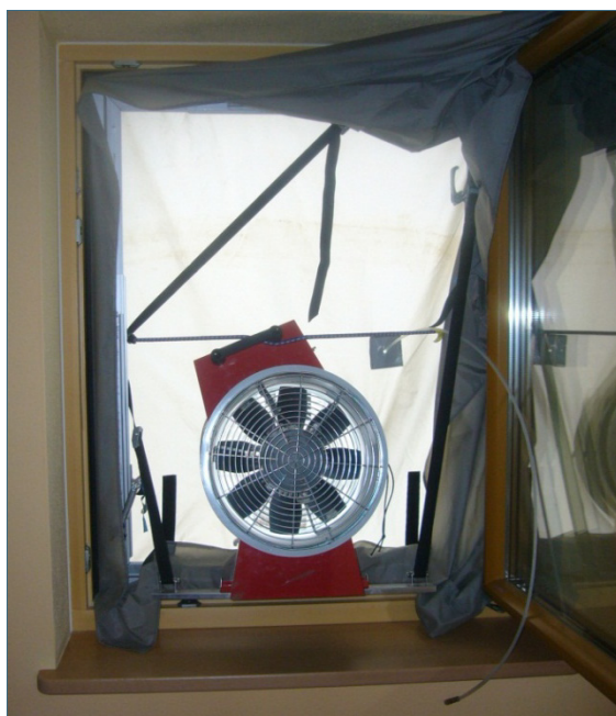
Abb. 16: Luftdichtheitstest zur Qualitätskontrolle in einem Wohnhaus.
