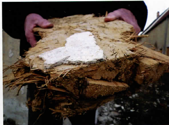
Im obersten Geschoss besteht der vermutlich über 300 Jahre alte Putz aus einer Mischung aus Stroh und Lehm, wie sie seit Jahrtausenden verwendet wurde.
